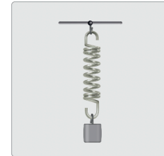
d) Esnek bir yayın ucuna asılan cismin bir miktar çekilip bırakılması ile düşey düzlemde aşağı ve yukarı yönde hareket etmesi
